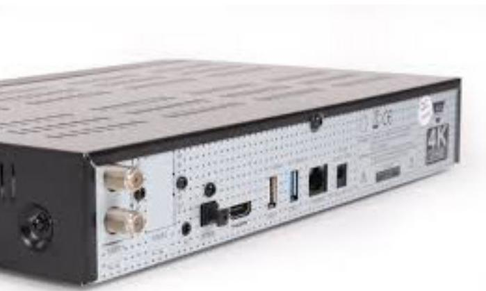
der Tuner. Unser Testgerät war mit einem DVB S2 Tuner bestückt und löste das Gerät ein Hybrid DVB-C/T2-Tuner (HEVC265) und ein DVB S2X-Tuner. DVB-S2X ist eine Weiterentwicklung von DVB-S2 und ist wesentlich effizienter als DVB S2.
