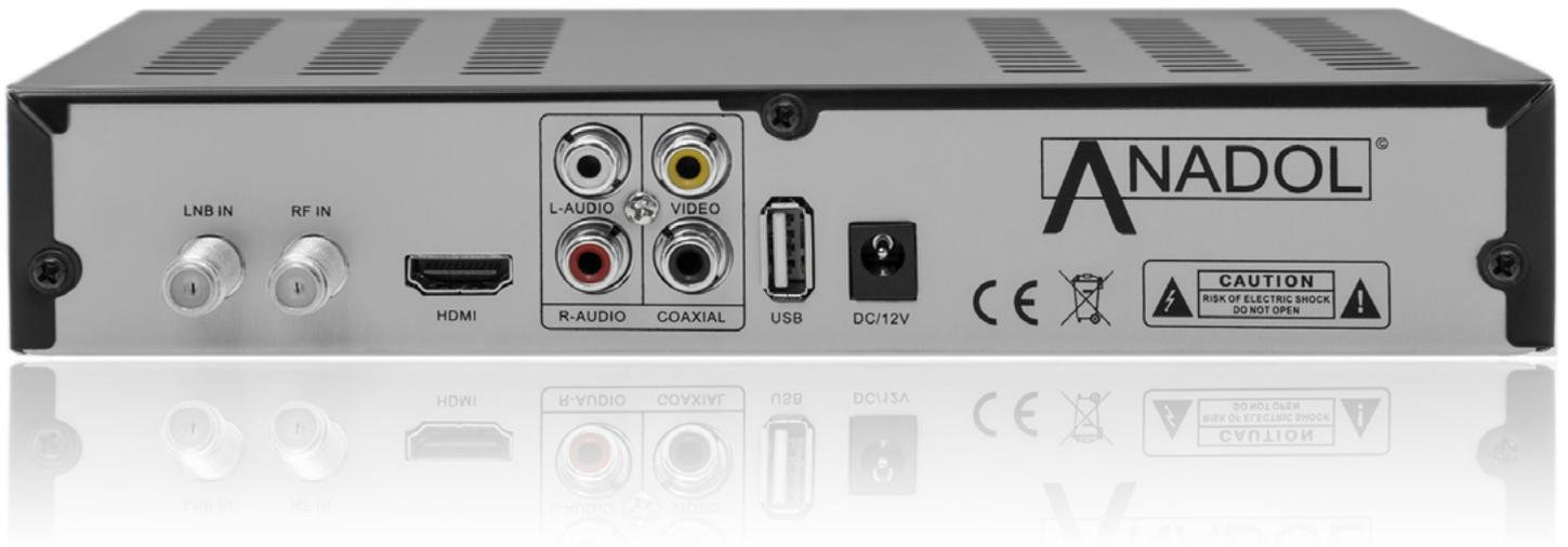
Die rückwärtige Seite ist mit dem LNB-Eingang bestückt und lässt die Durchschleifung des Signals zu einem weiteren Receiver zu. Analoges Audio liegt an zwei Cinch-Buchsen an. Ein koaxialer digitaler Audioausgang versorgt eine externe Soundanlage mit dem guten Ton. Eine weitere Cinch-Buchse liefert analoges Video für ältere TV-Geräte.
