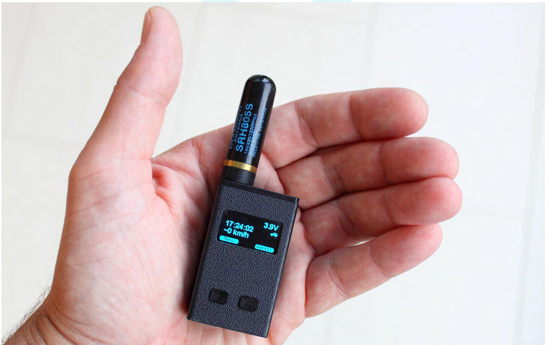
**Der PicoAPRS ist ein vollständiger Packet Radio Transceiver mit eingebautem TNC für APRS. Dabei kann der Transceiver nicht nur als APRS-Tracker und Empfänger für APRS Daten verwendet werden, sondern auch als TNC für den Computer. Hier wird das KISS Protokoll unterstützt.**
