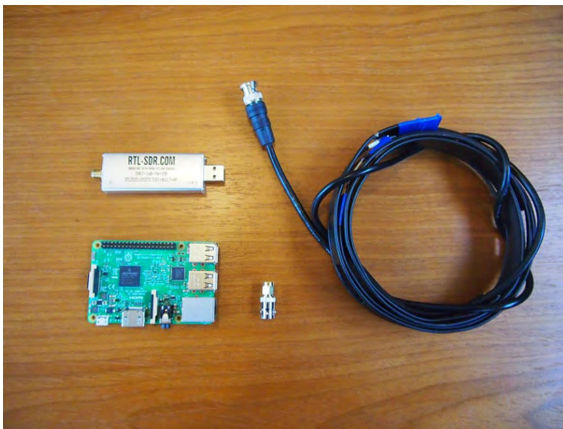
Eine permanente Station ist zwar besser mit einem Ethernet-Kabel verbunden, aber mit der eingebauten Wireless-LAN-Funktionalität der Raspberry Pi können wird nur das Stromkabel benötigt. Während viele mit Erfolg die billigsten Realtek SDR-Dongles verwendet haben, ist doch eher zu den etwas raffinierteren Versionen mit hoher Frequenz-Stabilität zu empfehlen. Zum Beispiel der RTL-SDR V3, RSP1A oder der HackRF One.
