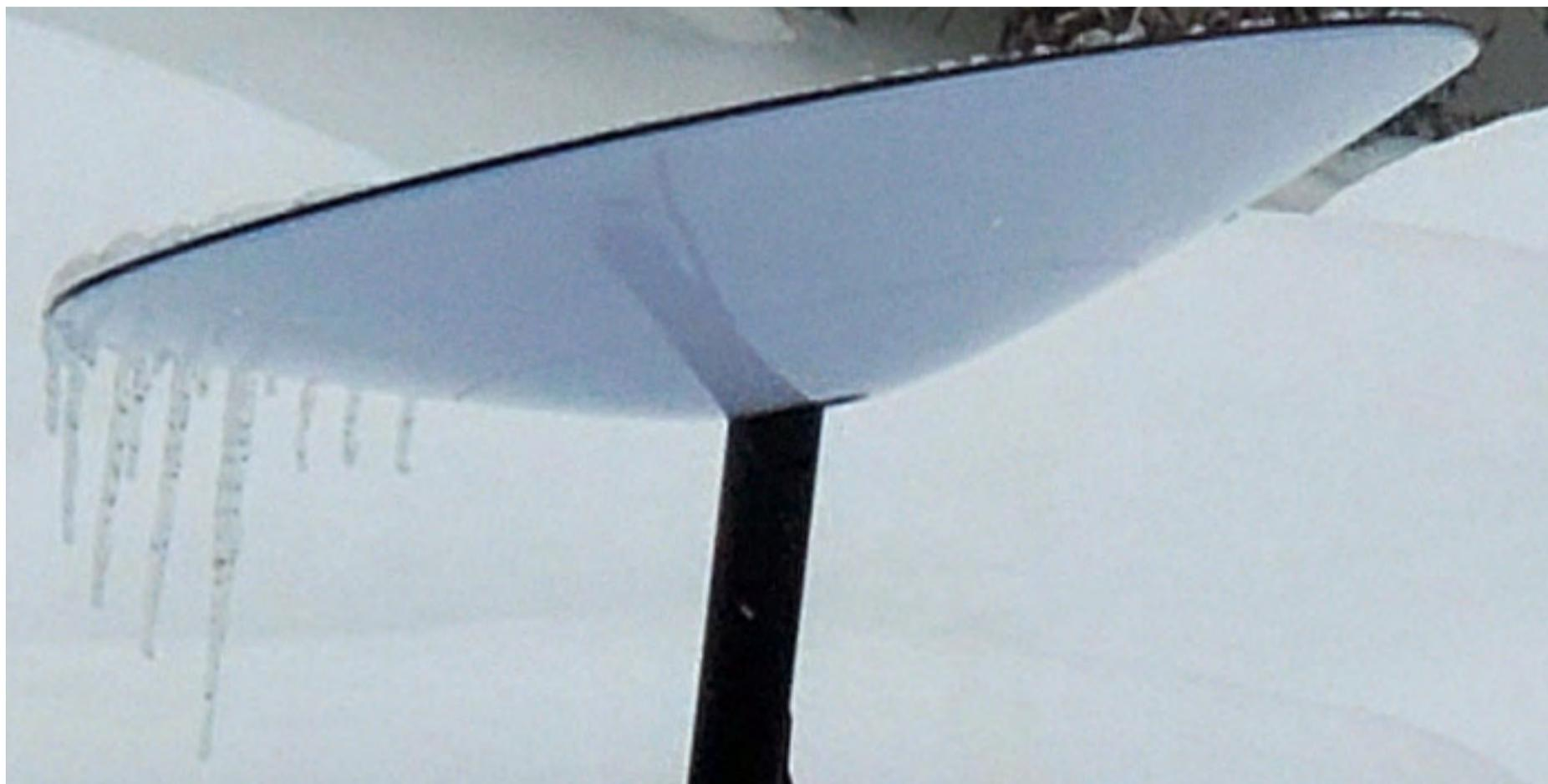
**Die eiszapfentropfende Schüssel auf dem Bild ist die Antenne für Starlink, dem satellitengestützten Breitbanddienst von SpaceX - einem der vielen Unternehmen von Elon Musk. Das Starlink-Paket traf kurz vor einem Schneeeinbruch in der Redaktion ein. Zum Glück ist die Antenne mit einer Heizung versehen, sodass sich nach der nächtlichen Kälte lediglich am unteren Rand ein „Eisbart“ bildete, der die Funktion in keiner Weise einschränkte.**
