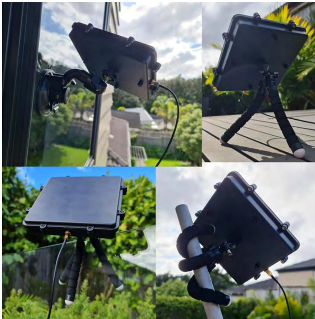
**Der RTL-SDR Shop liefert wieder die neue aktive L-Band Patch-Antenne. Die Antenne ist für den Empfang von L-Band-Satelliten wie Inmarsat, Iridium, GPS und anderen Satelliten, die zwischen 1525 - 1660 MHz senden, konzipiert. Die Antenne wird als Set mit einem großen Saugnapf, einem 3M RG174-Verlängerungskabel und einem biegsamen Stativ geliefert, das bei der Montage hilft.**
