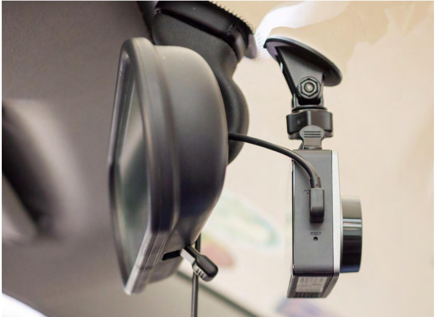
des Autos mit Strom versorgt. Besitzt das Modell darüber hinaus einen Akku, ist die kurze, vom Auto unabhängige Stromversorgung möglich. Für den Betrieb der Kamera beim Parken bieten sich Modelle mit leistungsfähigerem Akku an.
