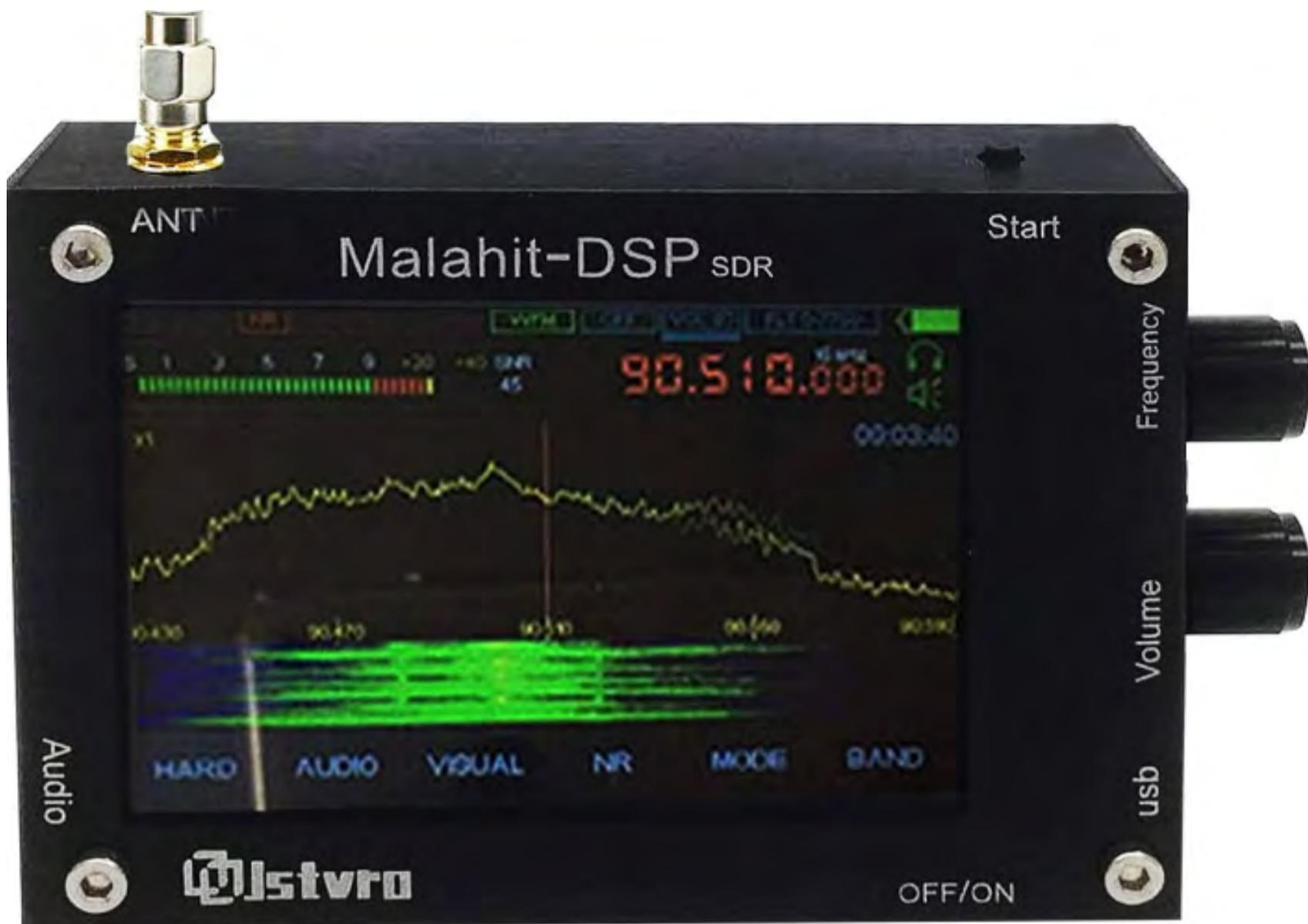
**Der Malahit DSP-2 ist ein russischer SDR-basierter Empfänger für die Lang-, Mittel-, Kurzwelle und VHF/UHR im Bereich 50 kHz bis 2 GHz. Verpackt ist die Elektronik in einem stabilen Gehäuse aus Aluminiumlegierung. Ausgestattet ist das Gerät mit einem kapazitiven 3,5-Zoll-Touchscreen.**
