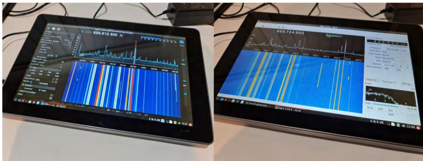
RasPad 3.0 mit eingebautem RTL-SDR, auf dem SDR++ und GQRX laufen
