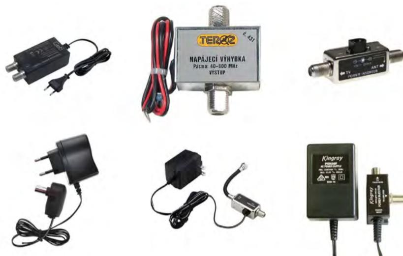
Eine 12-18-VDC-Stromversorgung - Die meisten Satelliten-LNBs benötigen 13 oder 18 Volt für den Betrieb, aber 12 Volt sollten auch ausreichen. Sie benötigen eine Möglichkeit, den Gleichstrom an den Power Injector zu liefern. Das kann ein USB-Anschluss/eine Powerbank mit einem DC-DC-Aufwärtswandler sein, oder einige Power-Injektoren werden mit ihren eigenen 12-V-AC-DC-Adaptern geliefert.
