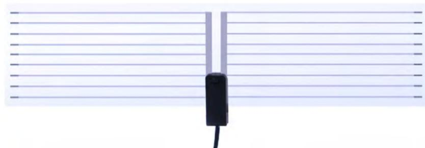
die logperiodische Antenne linear ausgelegt ist. Aber es funktioniert. Wie auch bei der Wendelantenne wird der Verstärker für 1,5 GHz direkt hinter die Antenne geschaltet. Wer Glück hat, findet im Internet für ein paar Euro eine „Outernet Patchantenne“ (diesen Begriff gogeln).<sup>1</sup>
